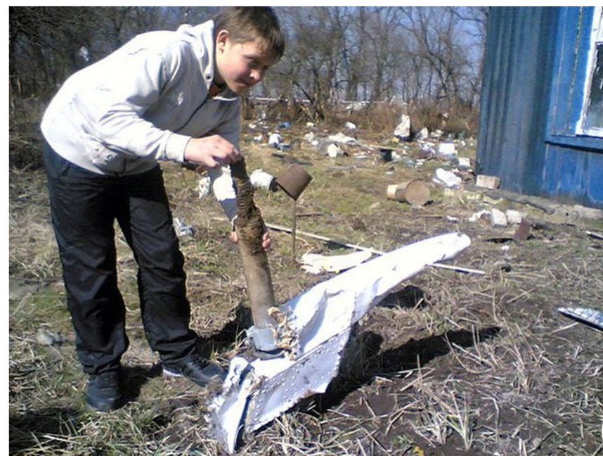
Aktuator srubowy klap znaleziony w poblizu szopy N. Bodina. Zrodlo: S. Amielin
