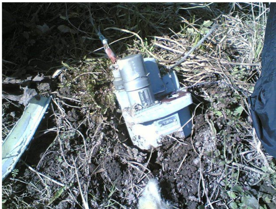
Hamulec elektromagnetyczny TЭM-4. Fotografia wykonana prawdopodobnie 10 kwietnia 2010 przed godz.18:44. Zrodlo: http://www.forum.smolensk.ws/viewtopic.php?p=6889622#p6889622 Autor: MAKS.
