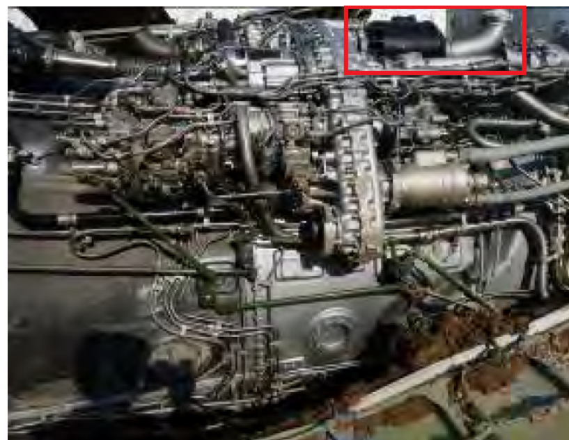
Generator ГТ40ПЧ6 na silniku No 1 (lewym). Pokrywa silnika została usunięta. Fotografia wykonana między 11 a 13 kwietnia 2010 na miejscu katastrofy. Źródło: Aneks No 4.10.22 to Raportu KBWL.
